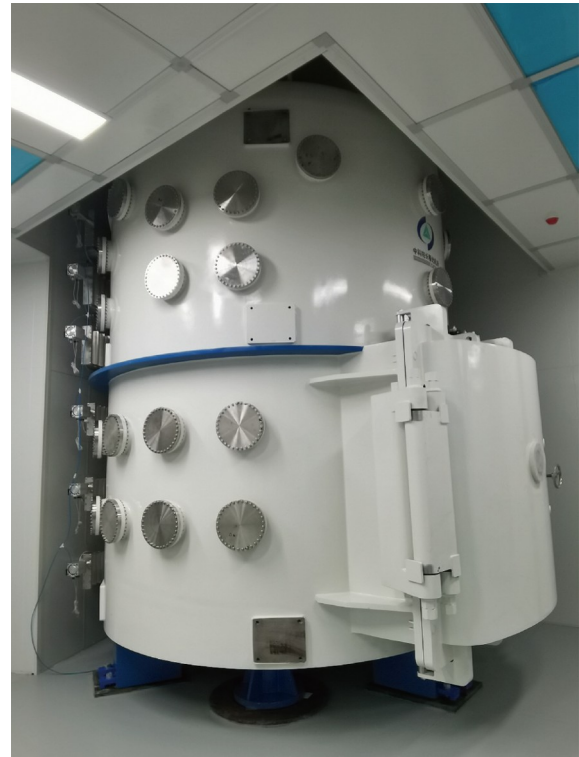
图 15 (网络版彩图)长春光机所在建多物理场综合弱力测量系统及地下十米实验室
